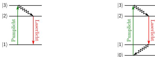
(a) Laser mit Dreiniveausystem: Anregung vom Grundzustand  $|1\rangle$  in das kurzlebige Niveau  $|3\rangle$ , nichtradiativer Zerfall in das langlebigere Niveau  $|2\rangle$ , Laserübergang zwischen den Niveaus  $|2\rangle$  und  $|1\rangle$ .
